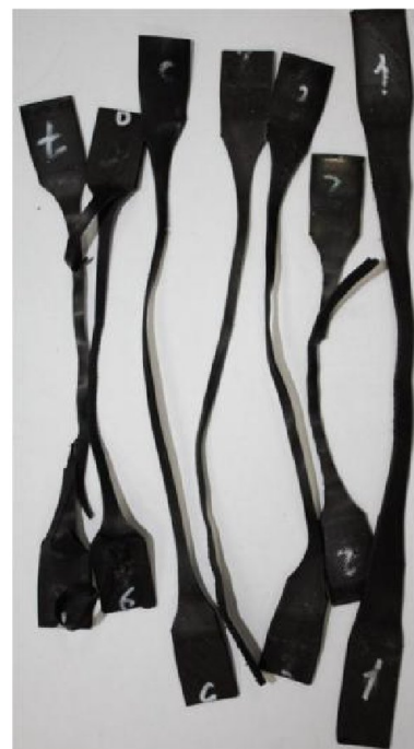
Фотографии элементарных образцов REC RUBBER после испытаний
